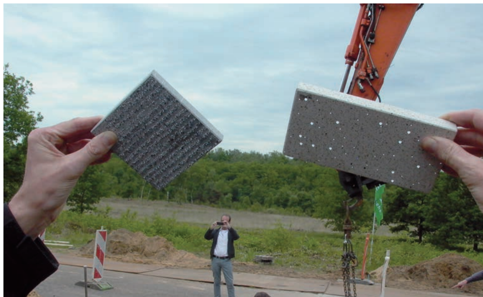
Foto 3: De combinatie van beton en glasvezel die de adders uitnodigt van de tunnel gebruik te maken (Foto Marcel van der Voort).
